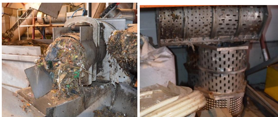
Jevnaker (NO), skruepresser med rejkt for enden, samt sigter
