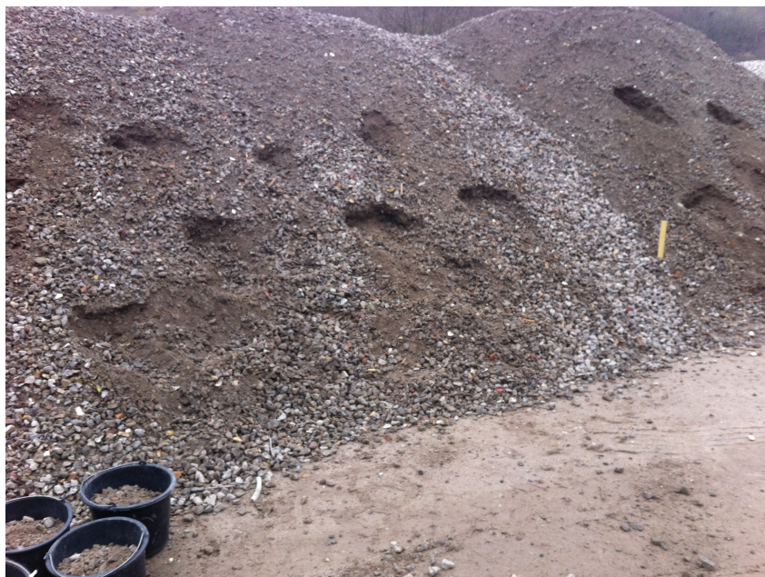
Billede 4: Beton mile efter prøveudtagning, Vestforbrænding
